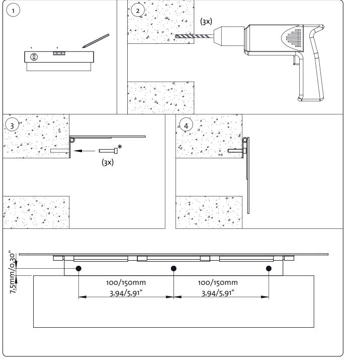
\*Hinweis: Verwenden Sie für die Montage geeignete Befestigungselemente.
